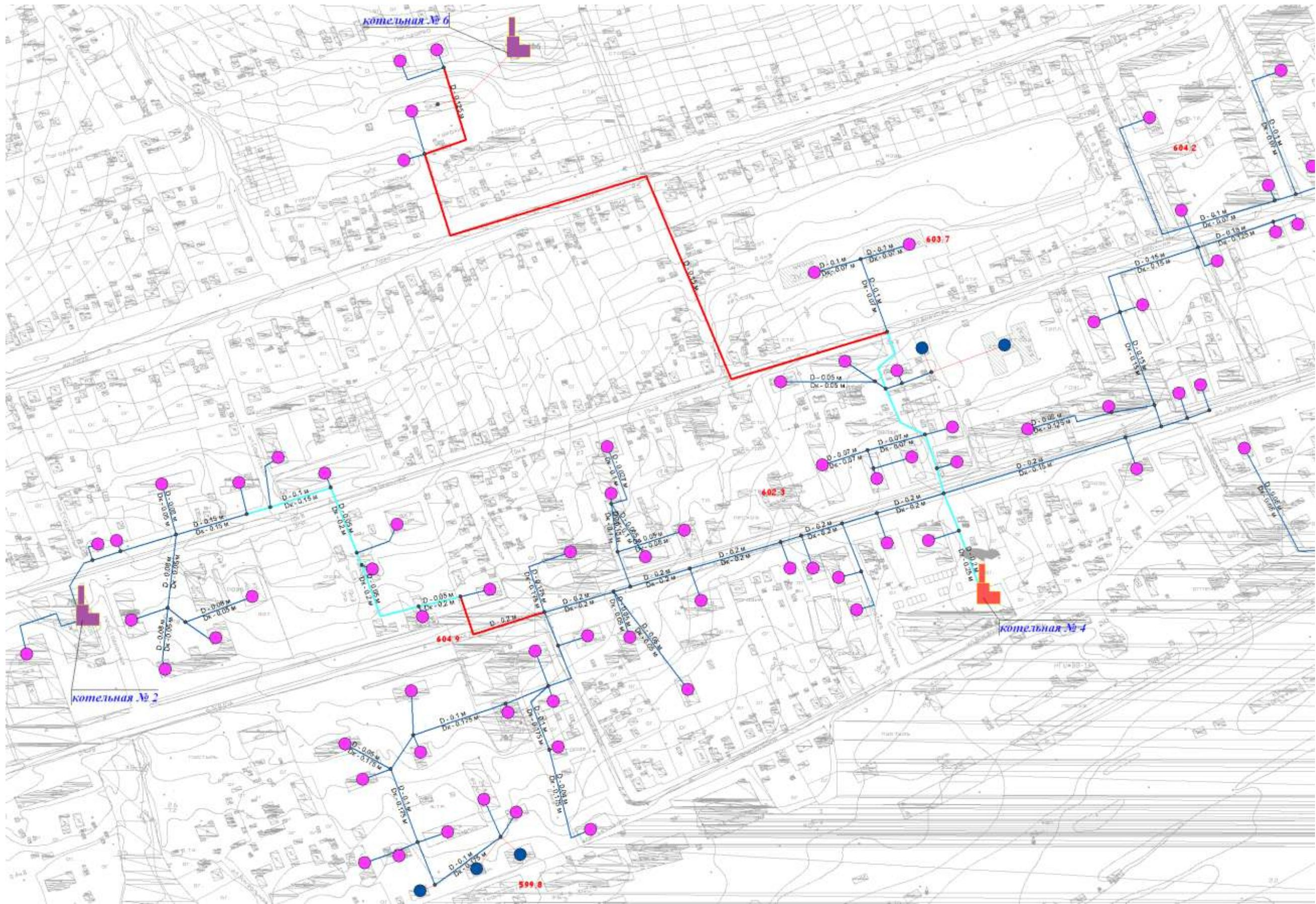
Рисунок 5.3 Трассировки тепловой сети котельной №4 к котельным №2 и №6
