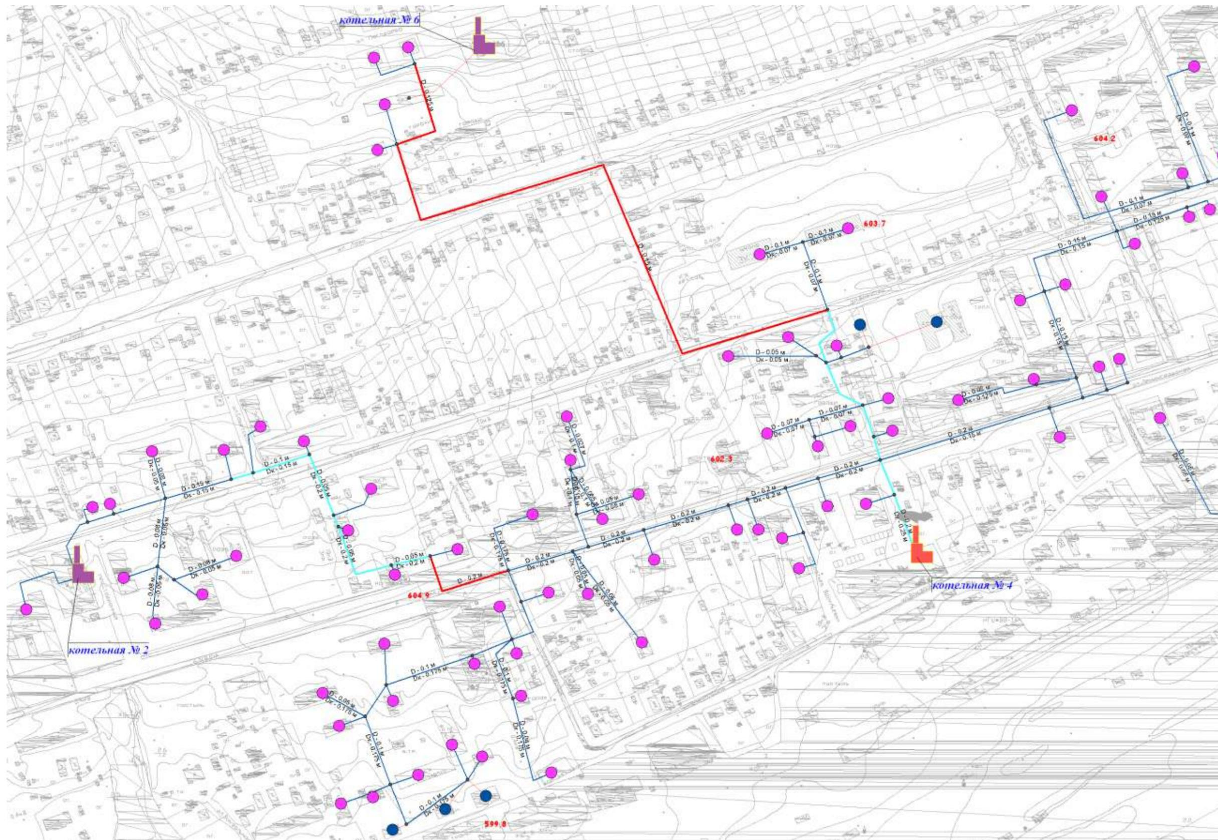
Рисунок 5.3 Трассировки тепловой сети котельной №4 к котельным №2 и №6
