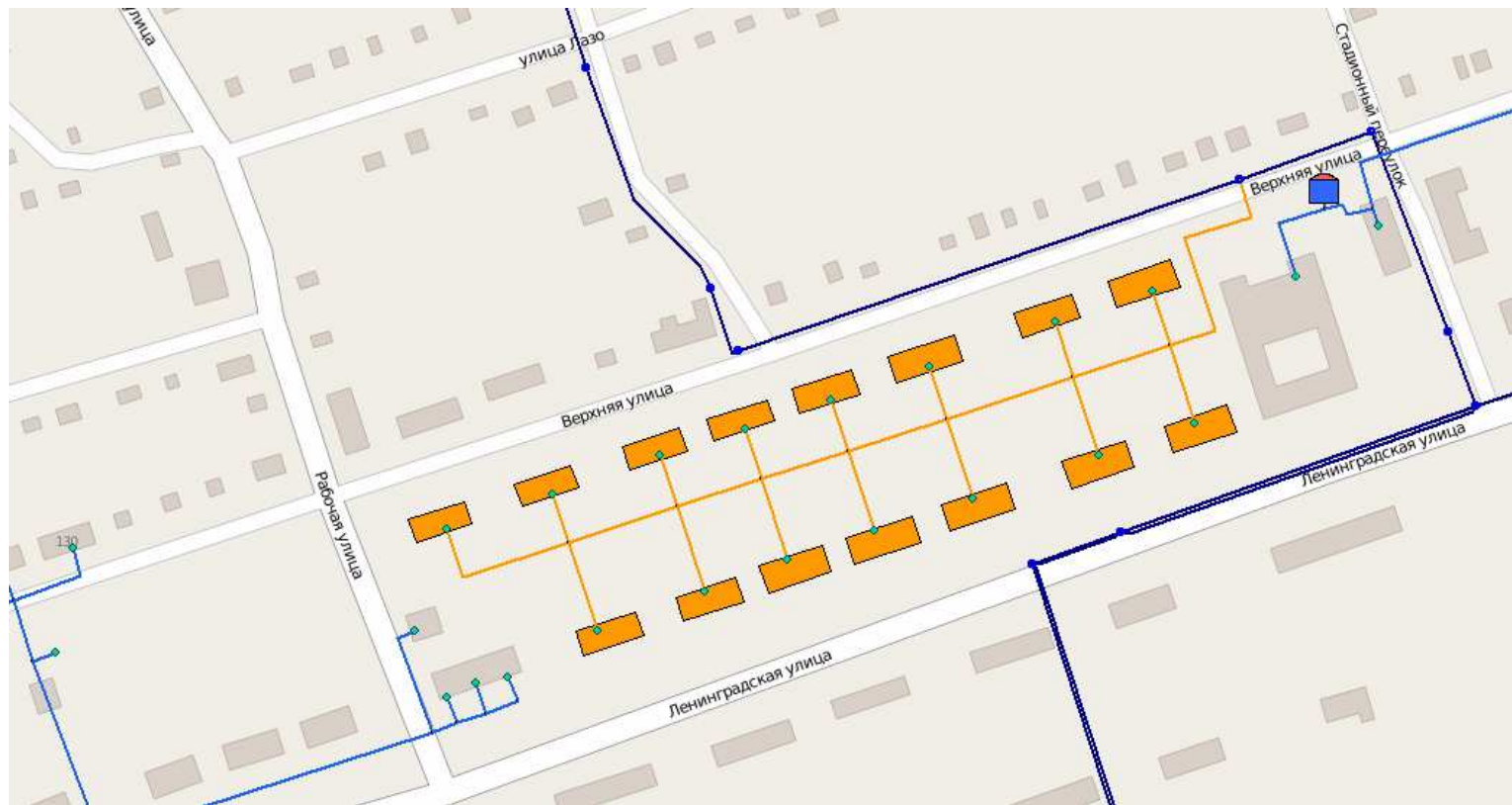
Рисунок 1. Предполагаемая трассировка водопроводной сети к новой жилой застройке
