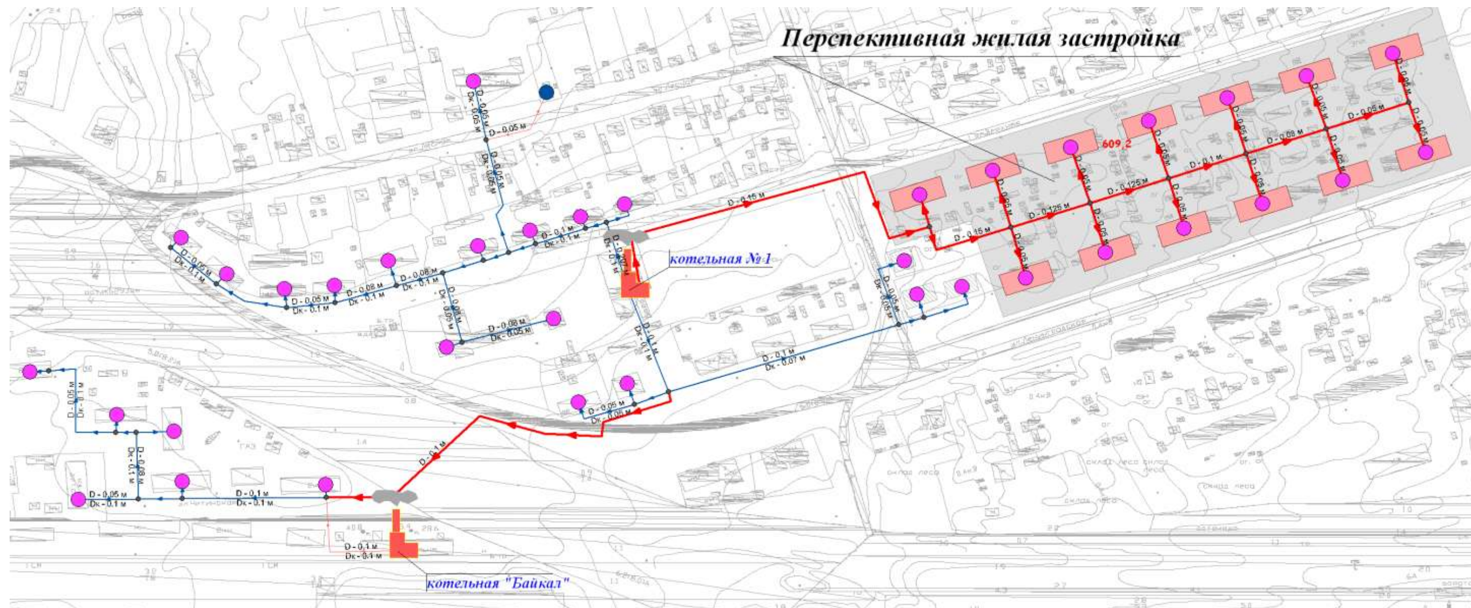
Рисунок 6.6 Трассировки тепловой сети от котельной №1 к домам по ул. Читинская
