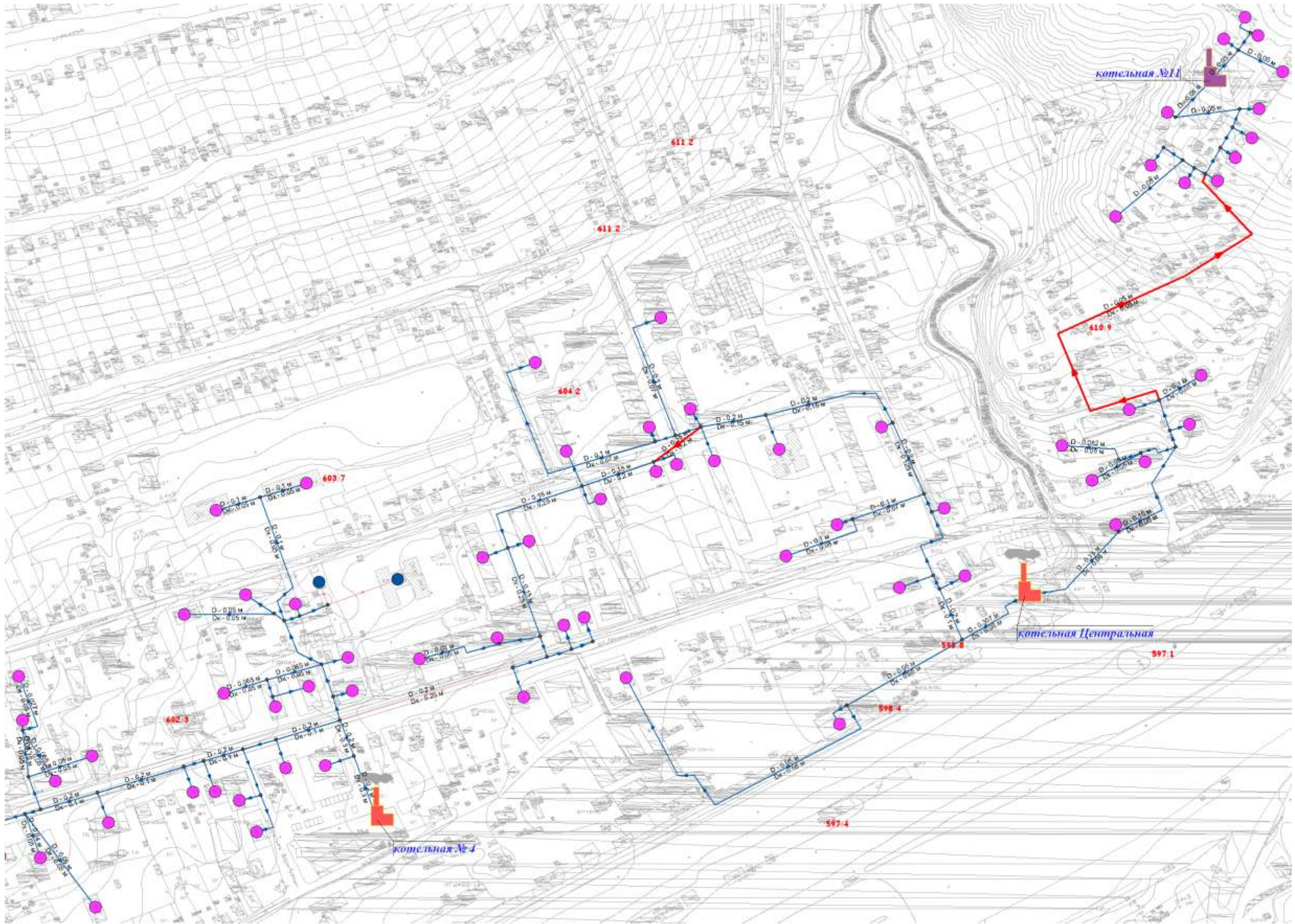
Рисунок 6.8 Трассировки тепловой сети от котельной УП к «Центральной» котельной
